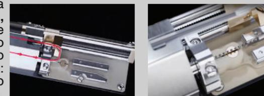
O tubo de retorno só abre após o jato de tinta ter sido ligado, evitando os problemas frequentes dos equipamentos comuns.
