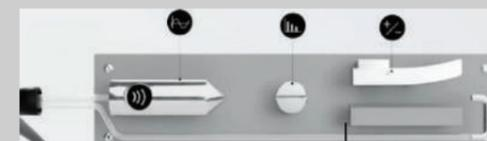
Conforme o equipamento é religado, a tinta seca, causando o entupimento ou desvio do jato, sujando os componentes do cabeçote e a linha do cliente.
